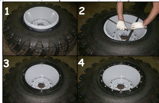
Рис. 10.4 Порядок монтажа шины ТРЭКОЛ
