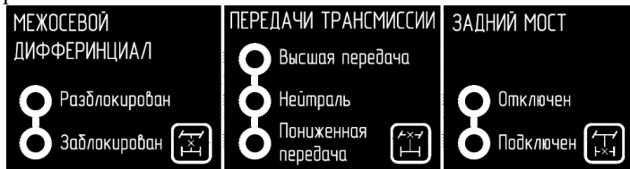
Рис. 6.4 Схема управления раздаточными коробками
