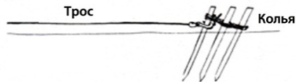
Рис. 19.8 Показывает пример правильного использования кольев. Это очень эффективный якорь, если почва позволяет им пользоваться. В землю их следует забивать под углом
