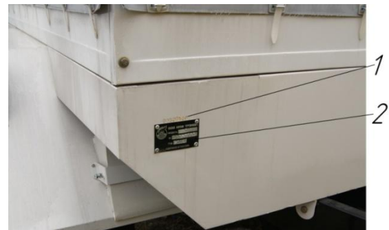
Рис. 2 Место обозначения заводского номера прицепа и расположение таблички заводских данных:
